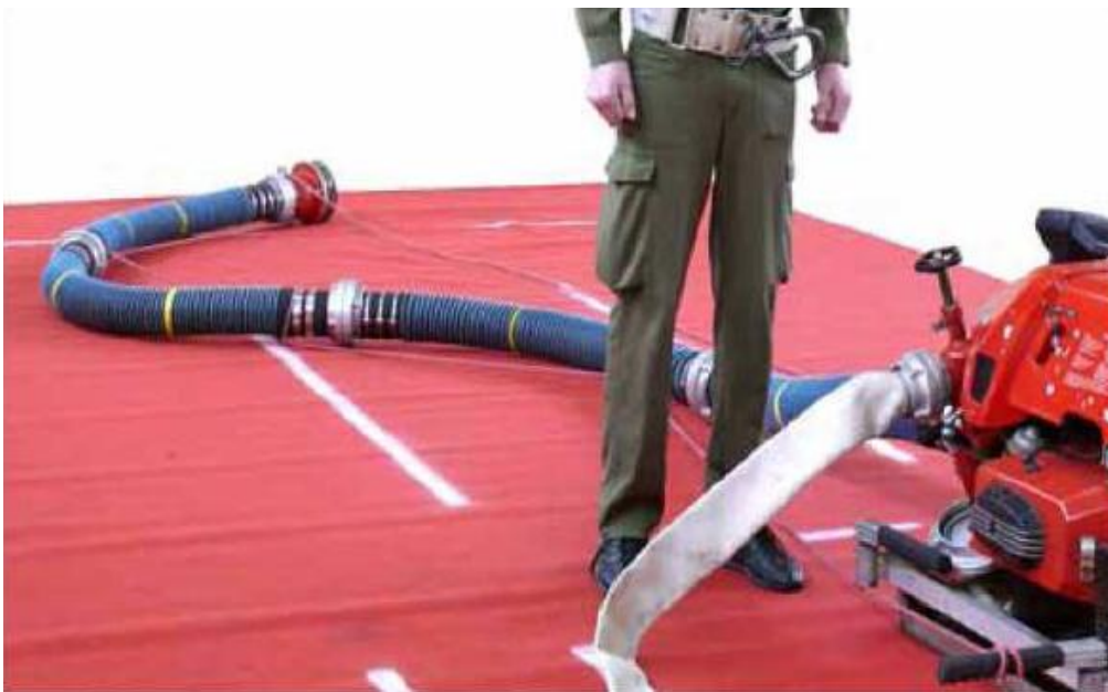
Obr. 16: Upevnění savicového lana na motorovou stříkačku
