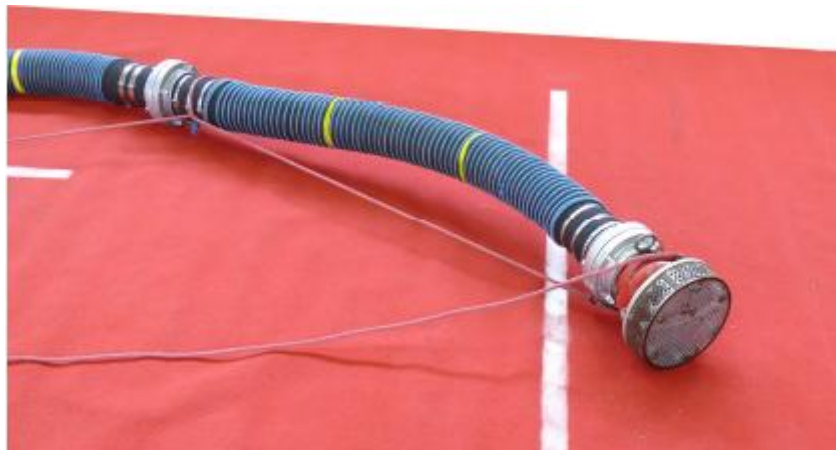
Obr. 13: Odložení sacího koše za hranici vody
