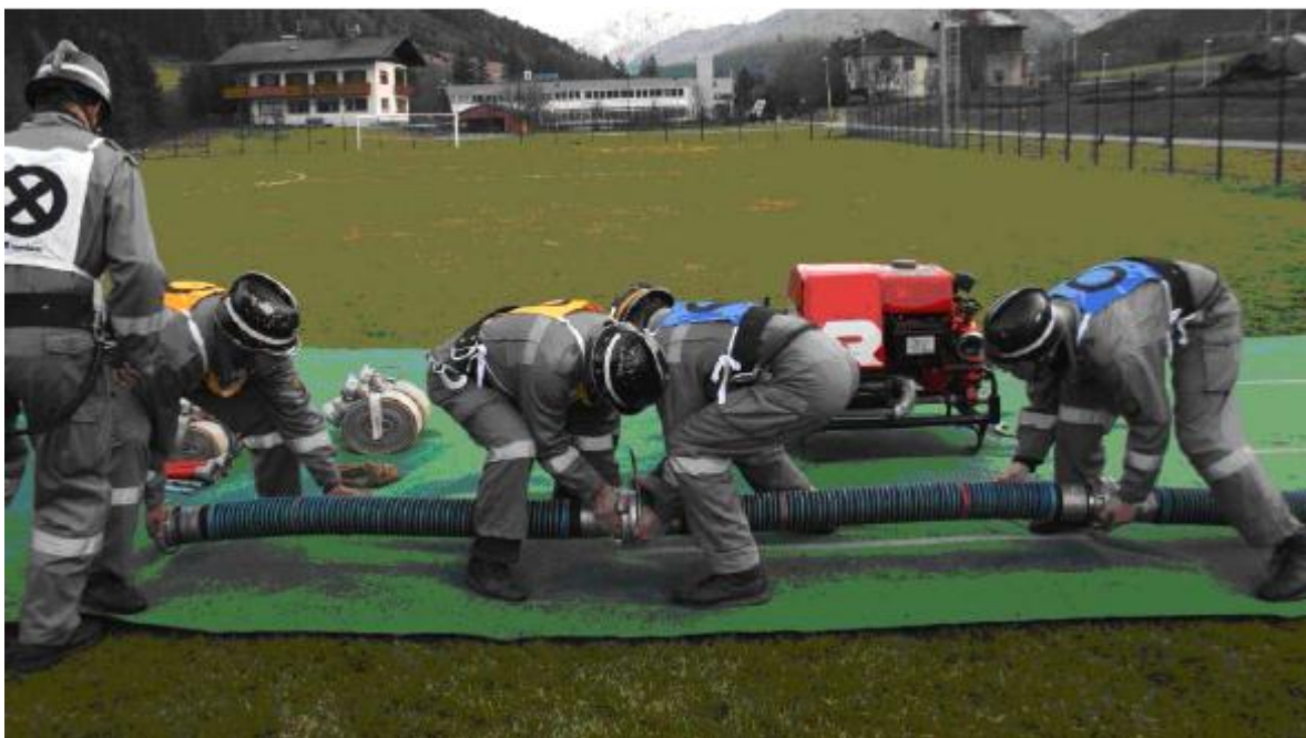
Obr. 7b: Spojování savic vodní a hadicovou skupinou
