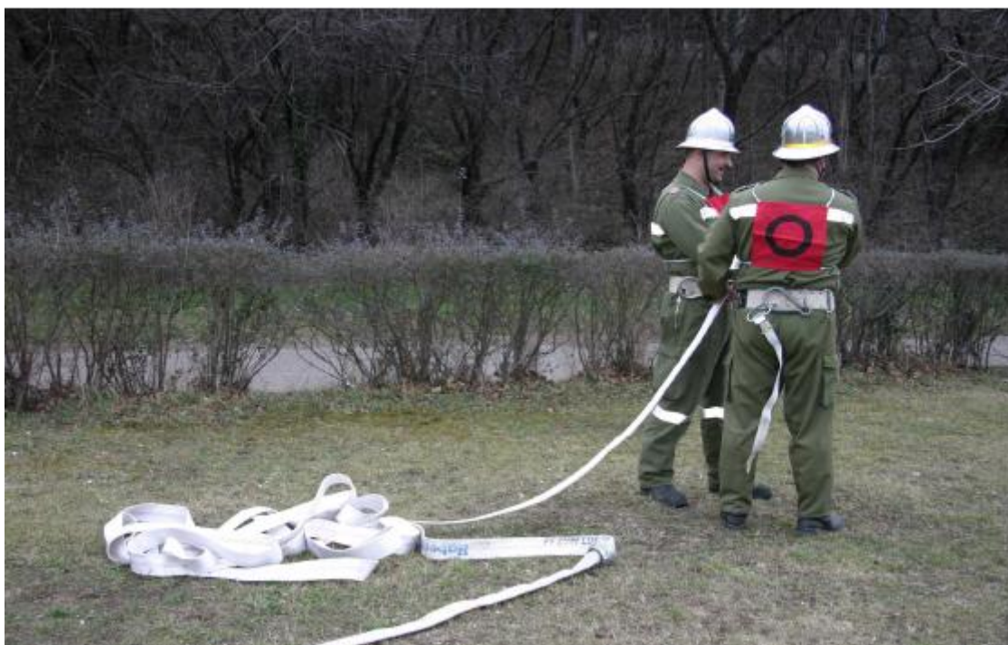
Obr. 21a: „Špatně rozložená tlaková hadice“ - „hromada“
