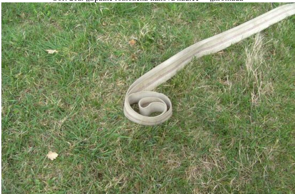
Obr. 21b: „Špatně rozložená tlaková hadice“ - „šnek“
